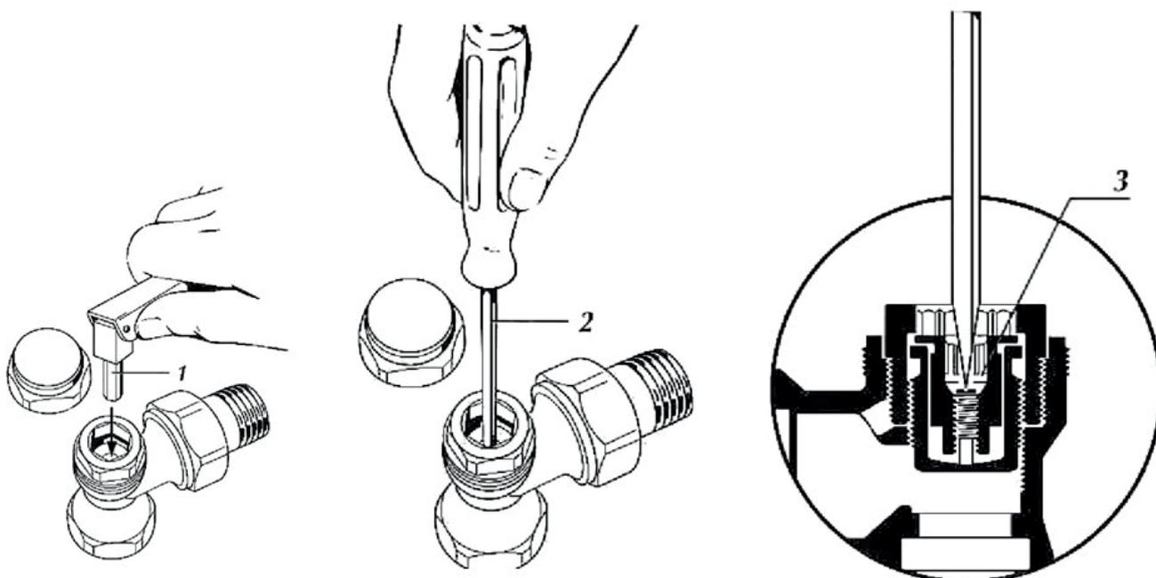
1. Retirer le bouchon. Tourner l'aiguille avec une clé adaptée (Allen ou outil 334) dans le sens horaire jusqu'à la butée.
