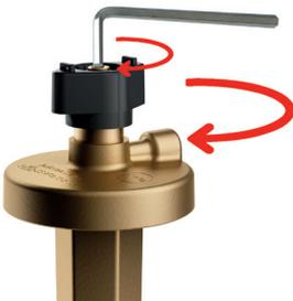
Um den Differenzdruckregler einzustellen, den Innensechskantschlüssel gegen den Uhrzeigersinn drehen, bis der Endpunkt erreicht und die Feder völlig entspannt ist. Ab diesem Punkt den Innensechskantschlüssel im Uhrzeigersinn drehen, bis der in der unteren Tabelle beschriebene Einstellwert (gewünschter Differenzdruck) erreicht ist.
