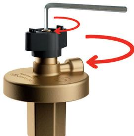
Per regolare il regolatore di pressione differenziale girare la chiave a brugola in senso antiorario fino a raggiungere il punto finale e a scaricare completamente la molla. A partire da questo punto, ruotare la chiave a brugola in senso orario fino a raggiungere il valore descritto nella tabella sottostante (pressione differenziale desiderata).
